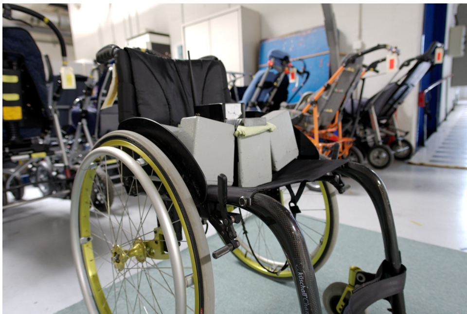
FIGURE II.10 – Photo du fauteuil équipé pour le test de décélération
