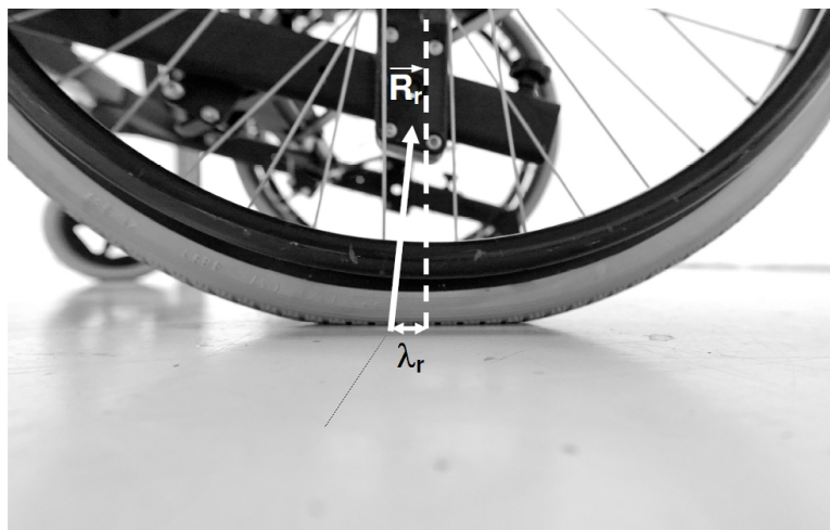
FIGURE I.1 – Déformation de la roue et résistance au roulement [Source : [117]]
