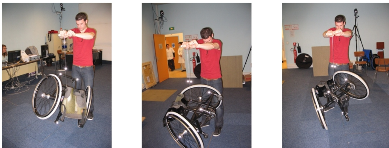
FIGURE IV.4 – Détermination du centre de gravité du fauteuil par suspension par trois points d'accroche différents
