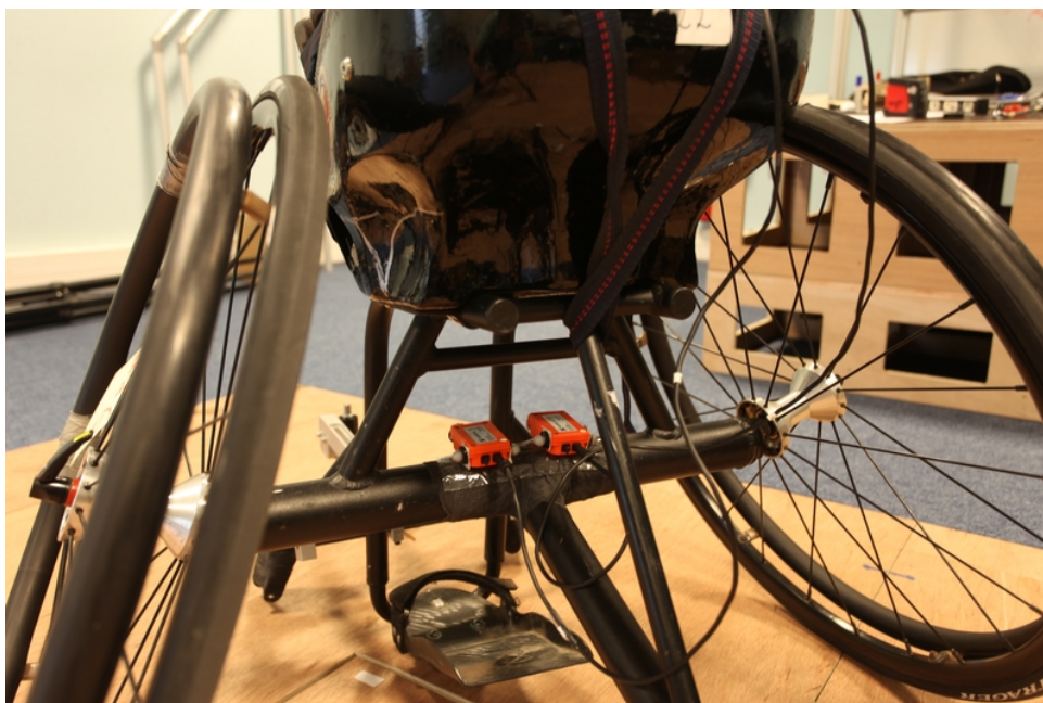
FIGURE VI.1 – Positionnement des centrales inertielles
